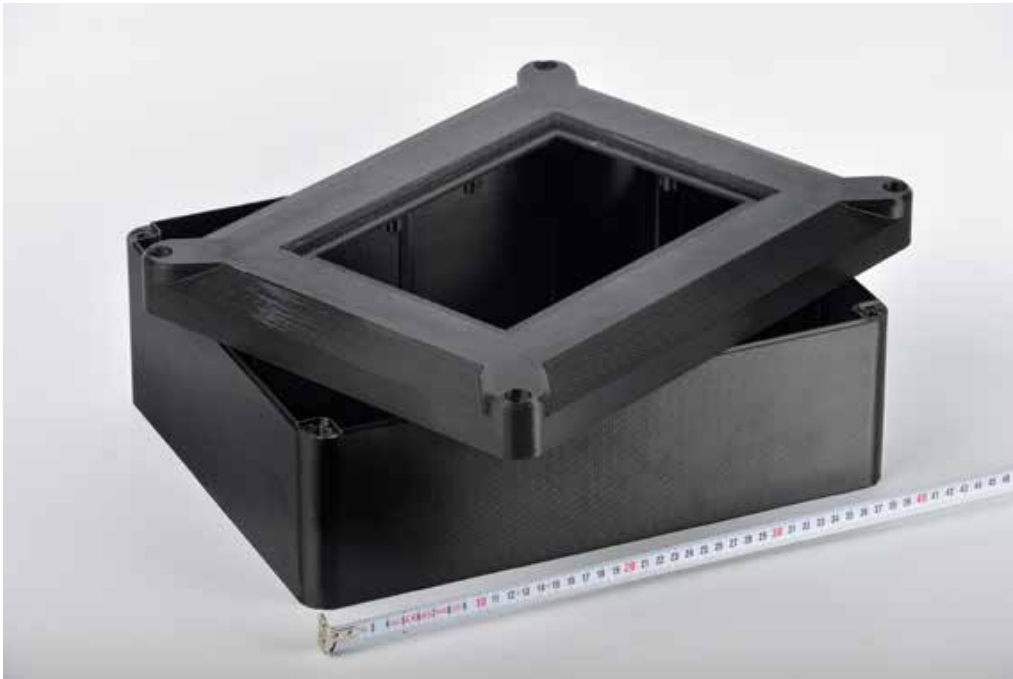
Ein Gehäuse für eine Steuerung im Agrarumfeld gefertigt aus ABS auf dem EL-102. Höchste Passgenauigkeit aufgrund geringster Verzugswerte wird durch eine fein geregelte Bauraumheizung erreicht.
