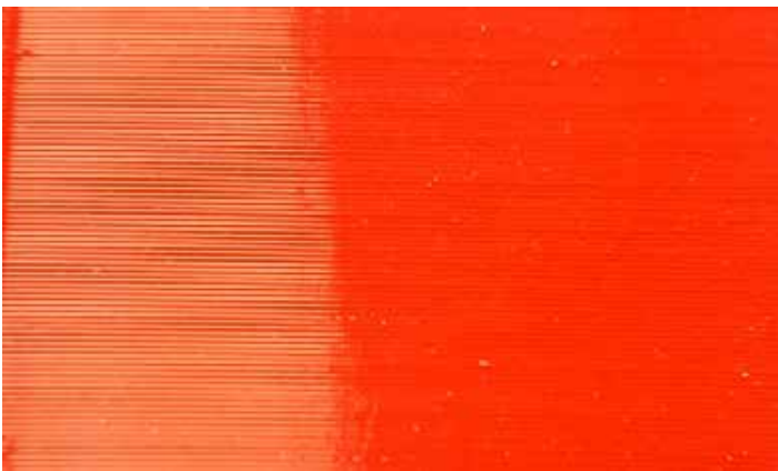
Die im EL-102 integrierte Filamenttrocknung sorgt für beste Ergebnisse. oben: zu feuchtes Filament. unten: Perfekte Filamenttrocknung
